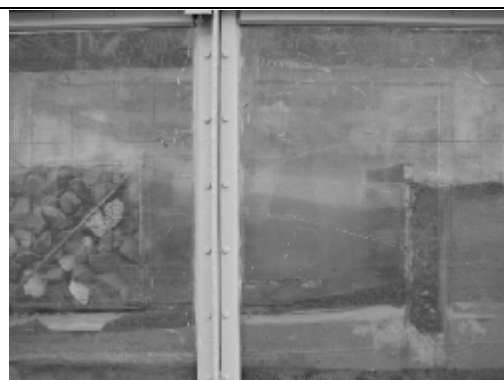
Рис. 7. Сооружение с «kozyрьком» и волноломом с дамбой и проницаемым волноломом.
