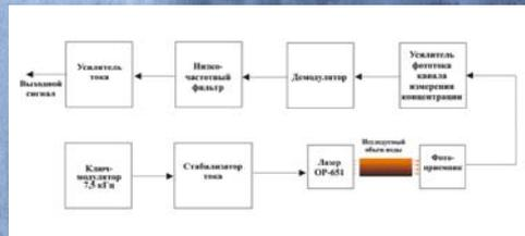
Блок-схема турбидиметра на лазерном диоде.
