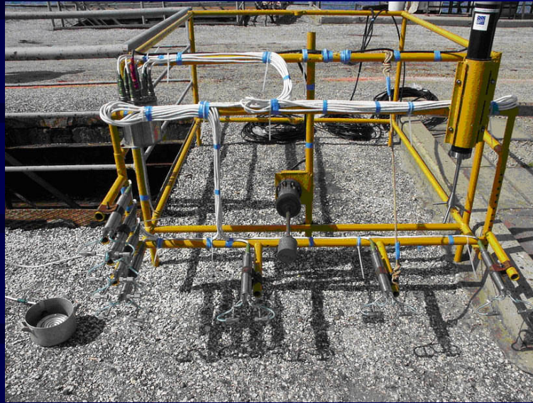
Носитель оборудования с установленными измерителями («Новомихайловка-2003»)
