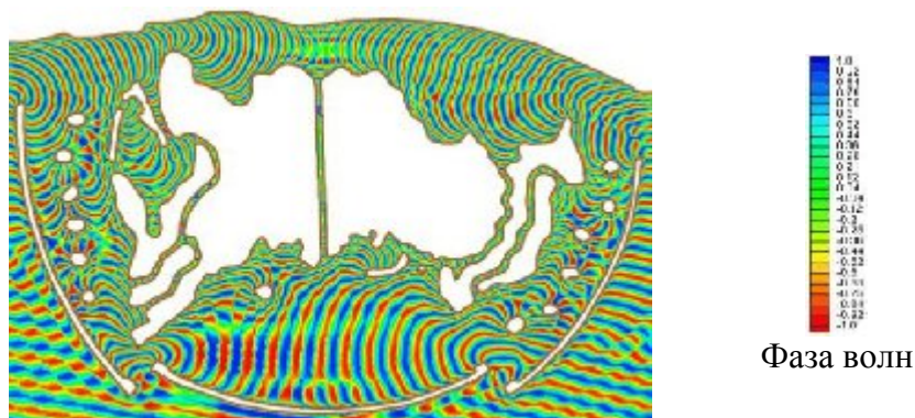
Рис. 8. Пример расчета распространения волн на защищенной акватории. Модель CGWAVE.
