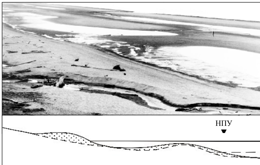
Рис. 4. Развитие берега со сбалансированным бюджетом наносов при повышении уровня воды, Новосибирское водохранилище
