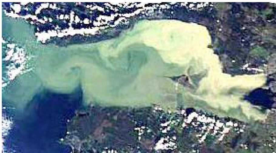
Рис.2. Космический снимок поля мутности воды от намывных работ, декабрь 2006
